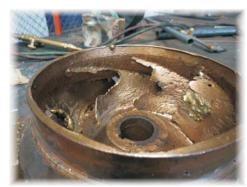
**Cliente:** Importante empresa del sector industrial **Ubicación:** Valle de los Chillos, Ecuador **Problema:** Impulsor de bronce con graves problemas de desgaste, erosión y cavitación generados por el paso continuo de agua de río. Fue clasificado como desecho.
