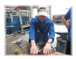
Solución: Limpieza y preparación de las superficies, reconstrucción y reparación de la pieza con **DURALLOY**, y finalmente 2 capas de **DURATOUGH DL** color verde, como acabado de protección
