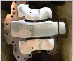
CHEMCLAD® SC es un sistema de polímero de dos componentes, 100 % sólidos, usado para crear una excelente capa protectora resistente a la corrosión y a los químicos en todo tipo de equipos y estructuras de agua potable.
